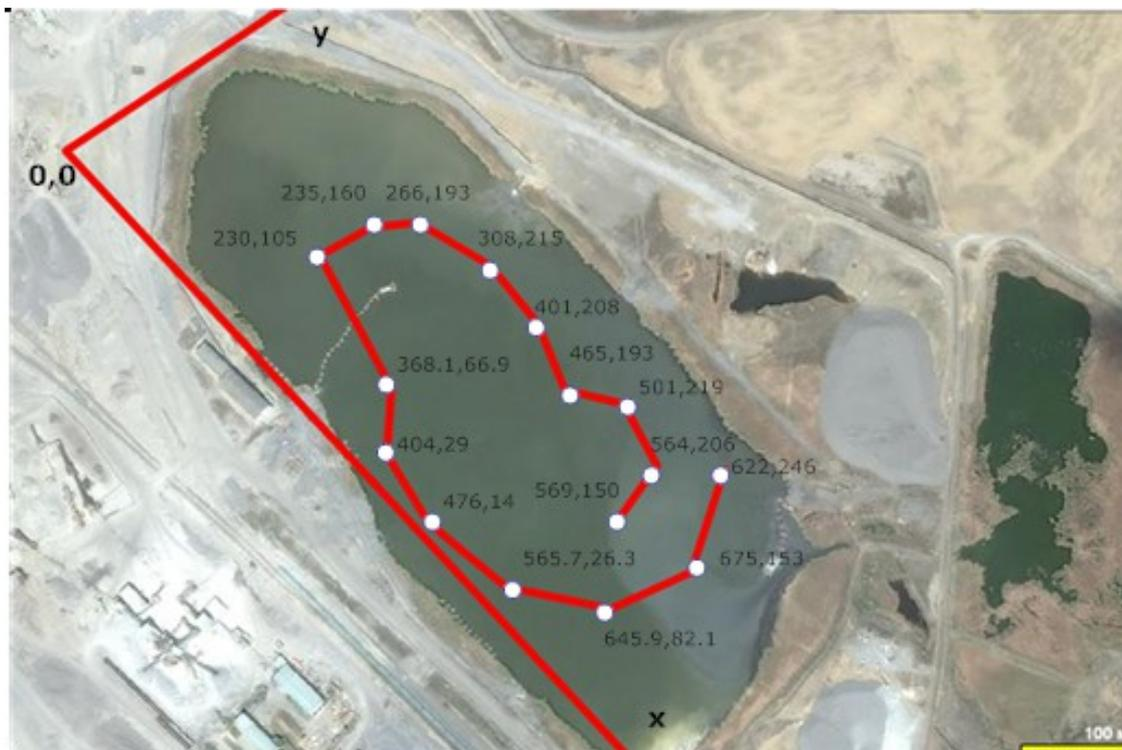
Рисунок 1 – Координаты точек отбора проб отходов золошлакоаккумулятора
